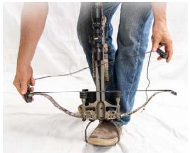
**MAKE SURE YOU USE YOUR COCKING AID EXACTLY THE SAME IS IF YOU WERE COCKING THE STRING AND ENSURE THE ROPE IS ROUTED AROUND THE GROOVE MOLDED IN THE STOCK LOCATED JUST UNDER THE SAFETY.**
